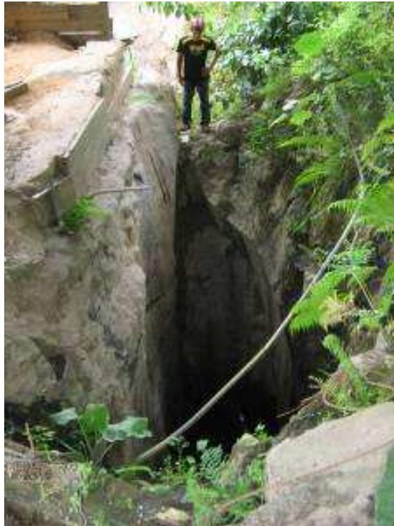
**FIGURA 7.7.4-48** – Garimpo de ouro do Galo – Poço para extração de minério primário.
