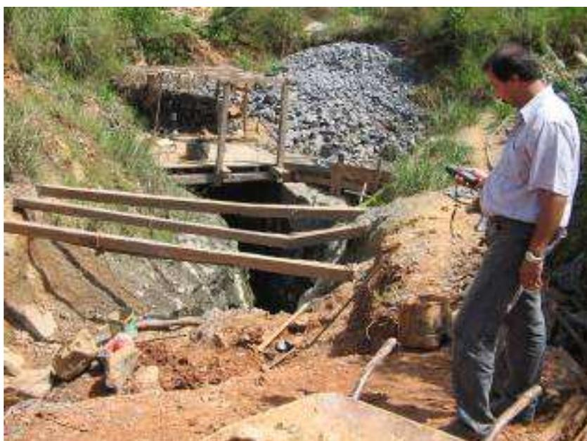
**FIGURA 7.7.4-47** – Garimpo de ouro Grota Seca – Extração de minério primário através de galerias.
