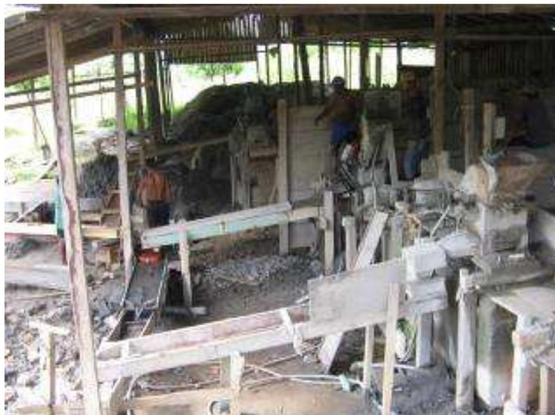
**FIGURA 7.7.4-49** – Garimpo de ouro do Galo – Instalação de beneficiamento do minério primário envolvendo britagem, moagem e concentração em caixas.
