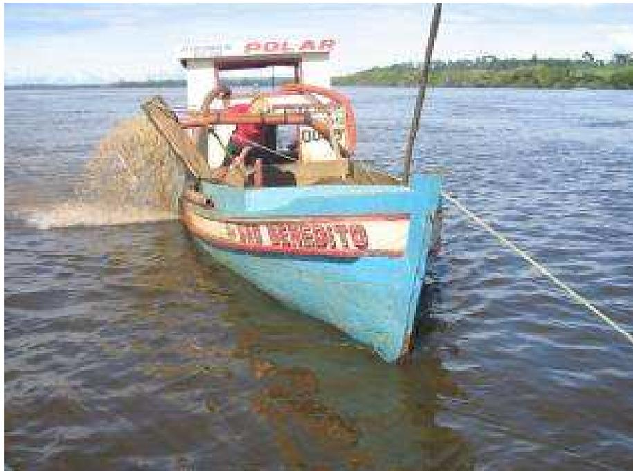
**FIGURA 7.7.4-66** – Extração de areia e cascalho no leito do rio Xingu, através de bomba de cascalho instalada em barcos.
