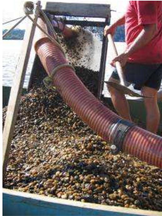
**FIGURA 7.7.4-67** – Detalhe da extração de cascalhos.
