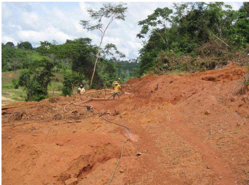
**FIGURA 7.7.4-46** – Garimpo de ouro Grota Seca – Lavra em depósito eluvionar.
