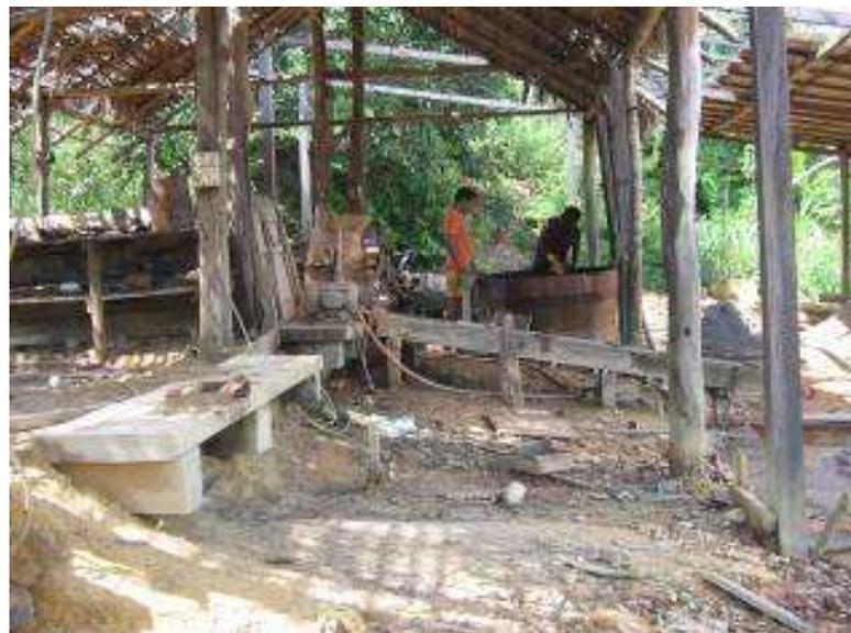
**FIGURA 7.7.4-51** – Garimpo de ouro Itatá – Tratamento do minério primário feito de acordo com o mesmo padrão utilizado nos demais garimpos da região. O material retido nas caixas é amalgamado com mercúrio, sendo o ouro recuperado após a volatilização do mercúrio.
