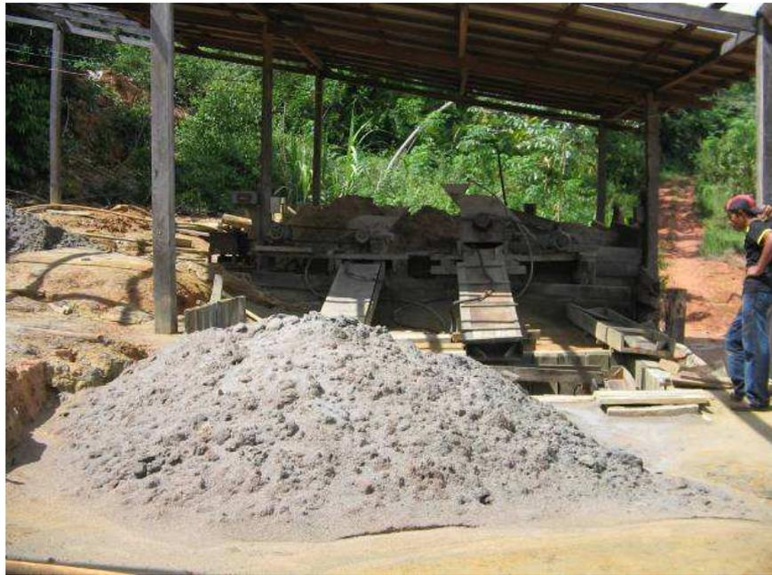
**FIGURA 7.7.4-52** – Garimpo de ouro Itatá – Pré-concentrado das caixas.
