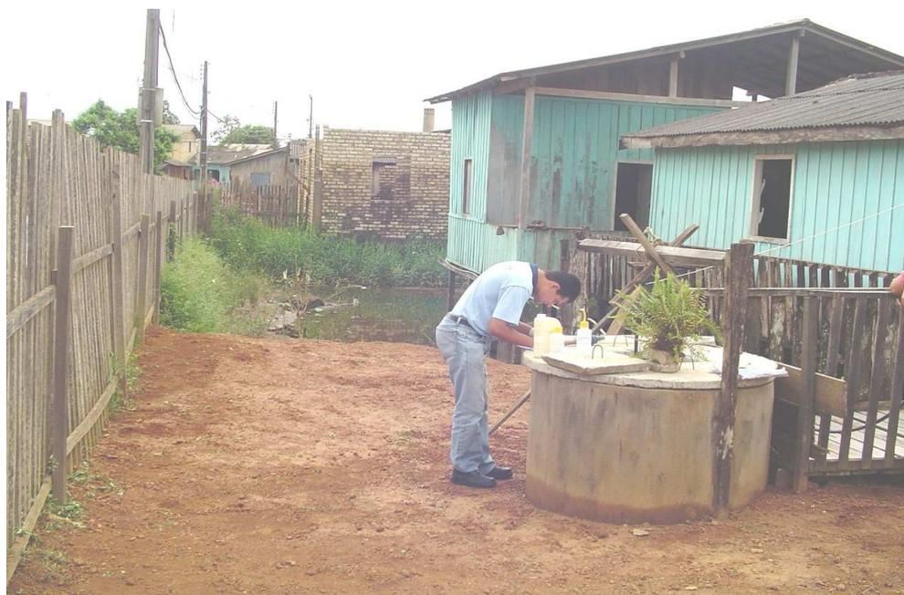
**FIGURA 7.7.3-4** – Poço raso na cidade de Altamira incluído no cadastro das campanhas de hidrogeologia e selecionado para coleta de amostras para análise de qualidade da água.
