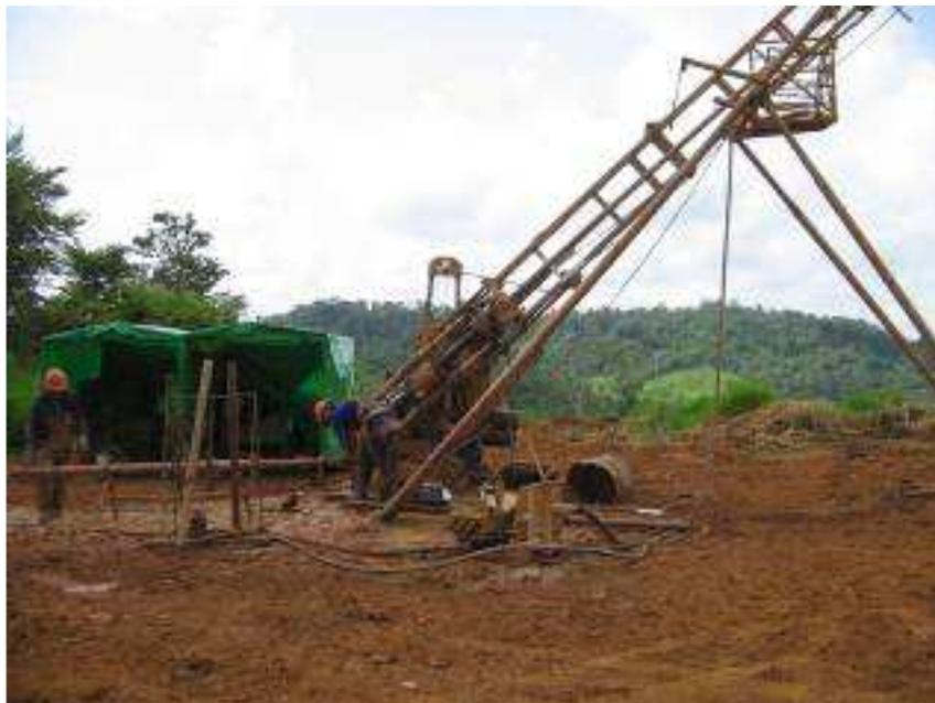
**FIGURA 7.7.4-40** – Sondagem em execução pela Geosol, para a Verena Mineração, entre os garimpos Ouro Verde e da região da Ressaca, para avaliação da reserva aurífera na área.
