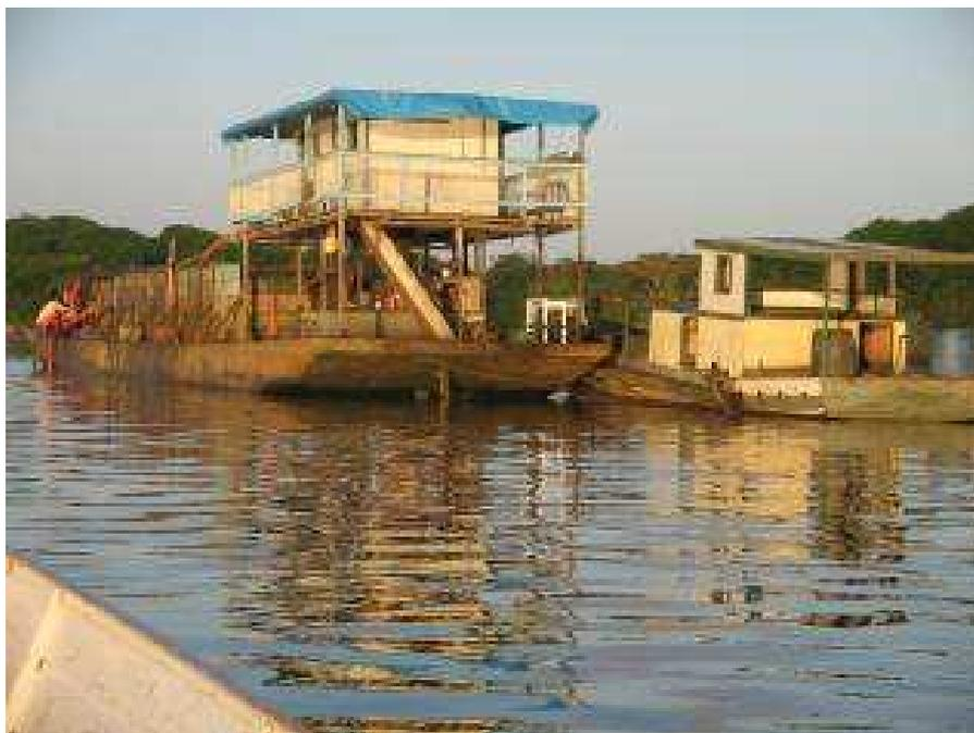
**FIGURA 7.7.4-68** – Extração de areia e cascalho com equipamentos de dragagem e beneficiamento instalados em balsa com capacidade para 40 -50 m<sup>3</sup> por viagem.
