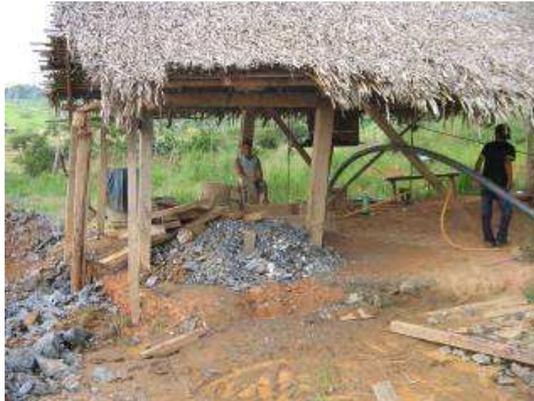
**FIGURA 7.7.4-42** – Garimpo de ouro Serrinha – Fragmentos de rocha com veios de quartzo auríferos (frisos) extraídos através de lavra subterrânea.
