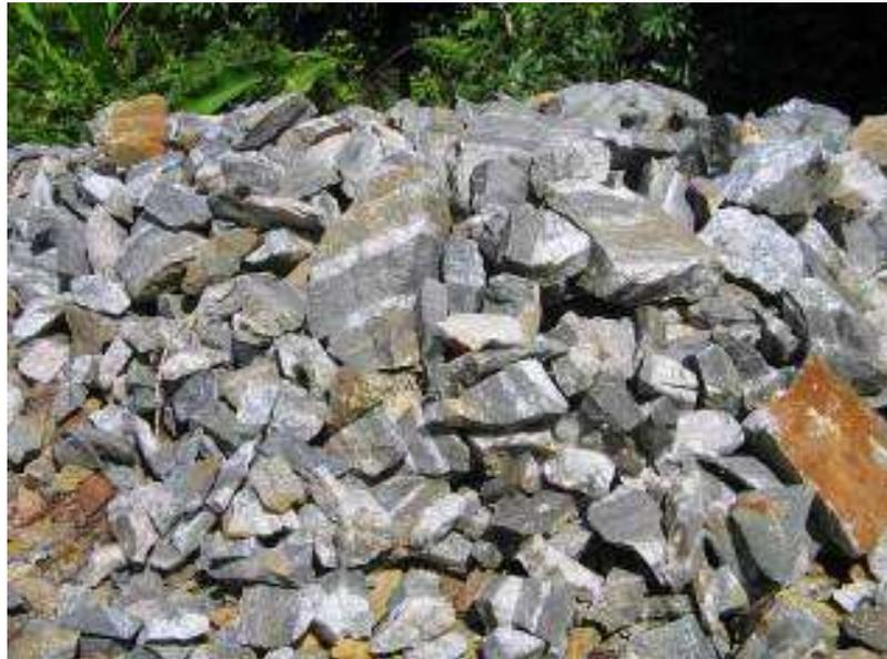
**FIGURA 7.7.4-50** – Garimpo de ouro Itatá – Minério extraído estocado para beneficiamento, observando-se a rocha metabásica com os veios de quartzo auríferos (faixas claras).
