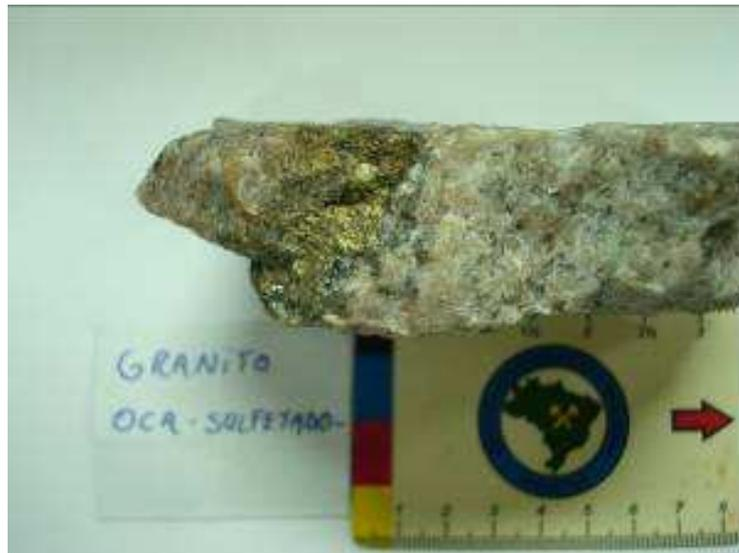
**FIGURA 7.7.4-15** – Amostra de mão do Granodiorito Oca sulfetado.
