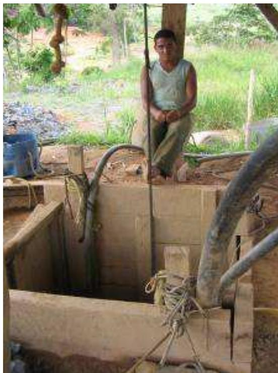
**FIGURA 7.7.4-41** – Garimpo de ouro Serrinha – *Shaft* para extração do minério.
