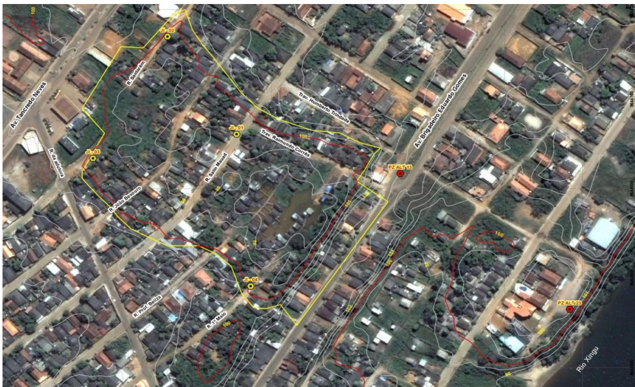
Figura 08 – Malha de poços/medidores pertinentes à intensificação do monitoramento do lençol freático no entorno da área de baixo no Jardim Independente II.
