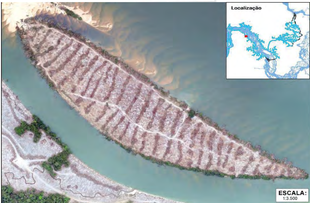
Figura 25: Limpeza de bordas e enleiramento de resíduos - RX Ilha Lourenço
