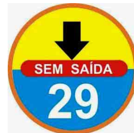
P03 – placa indicativa de local sem acesso nem saída de emergência
