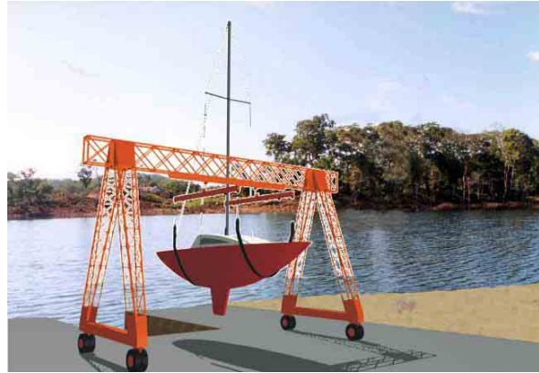
FIGURA 80 – IÇAMENTO DO BARCO, ATRAVÉS DE PÓRTICO, ATÉ A CARRETA QUE O LEVARÁ AO LOCAL DE ESTACIONAMENTO DEFINITIVO
