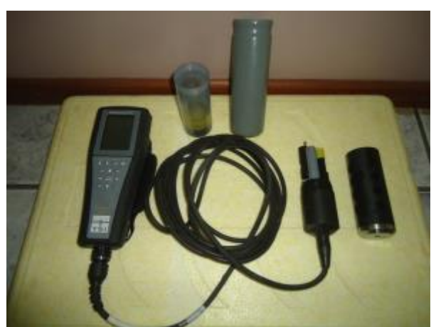
Foto 640: Equipamento portátil para medição de parâmetros in loco . Foto: Ampla, 2013.
