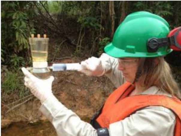
Foto 641: Filtragem de água para análise de metais. Foto: Amplo, 2013.
