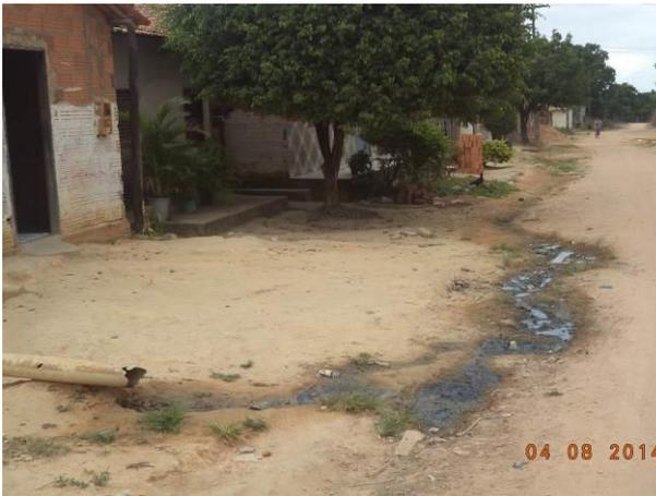
Foto 5: Esgotamento sanitário lançado a céu aberto na Sede Municipal de São Pedro da Água Branca - MA.
