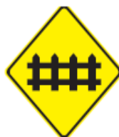
A-40 Passagem de nível com barreira
