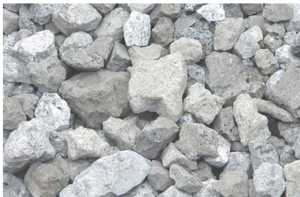
Foto 21: Lastro de pedra britada
