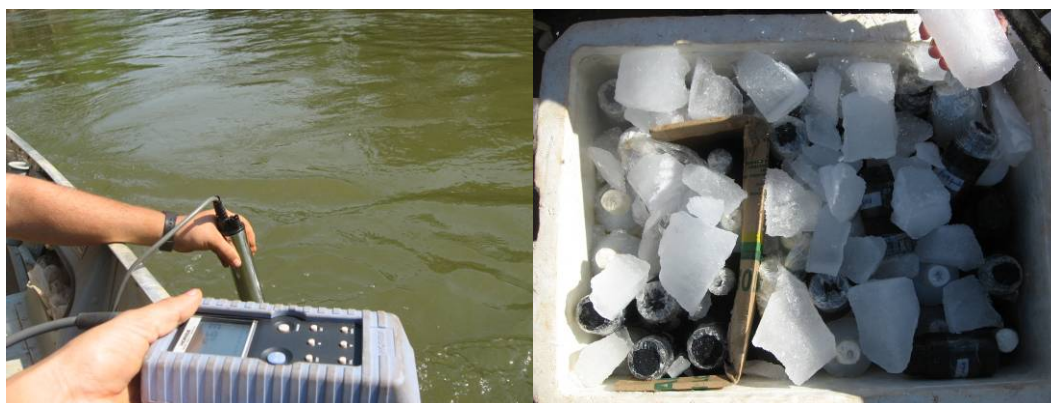
Foto 46: Coleta de dados in situ , com sonda multiparamétrica.
