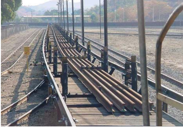
Foto 10: Exemplo de vagões especiais para o transporte de barras de trilhos soldados
