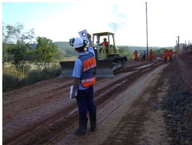
Foto 39: Controle de emissão de fumaça preta através de escala Ringelmann
