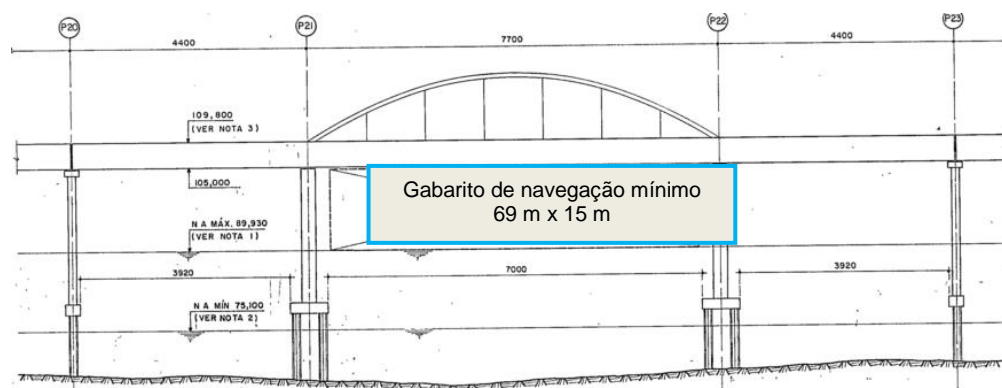
Figura 8. Vista longitudinal do trecho 3, contemplando arco metálico e gabarito para navegação
