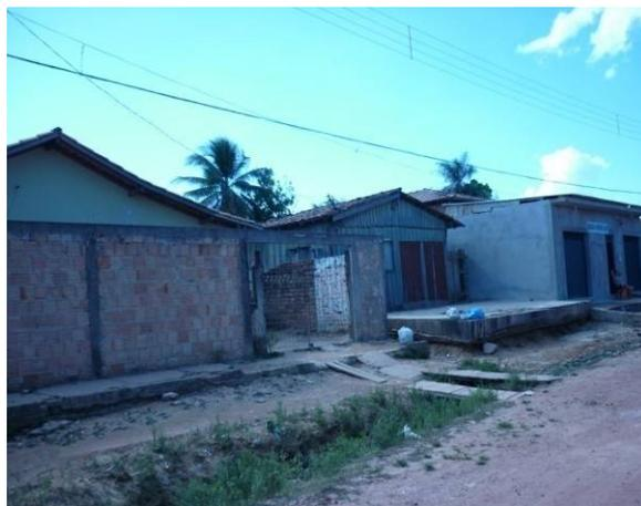
Foto 5.3-606: Vala negra na proximidade do passeio para lançamento de águas servidas. Detalhe a direita para antiga casa da COHAB de madeira. Folha 5, Marabá/PA.
