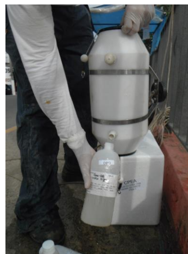
Figura 5.2.5.1.3-2. Transferência da amostra de água superficial da Garrafa do tipo Van Dorn para o frasco apropriado.
