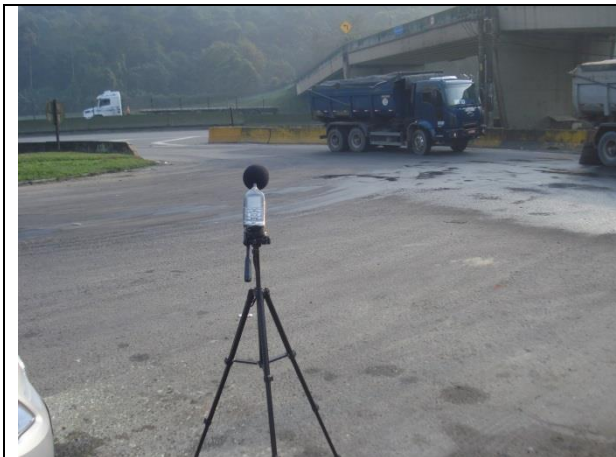
Figura 4.5.3 - 13: Vista do medidor de ruído a partir do ponto de medição 3
