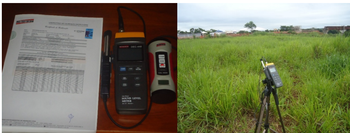
Figura 5.5.1 – A) Medidor de Nível de Pressão Sonora modelo DEC-440 e calibrador acústico CAL-5000. B) Equipamento montando em campo sobre tripé de apoio à altura de 1,2 a 1,5 m do solo conforme NBR.
