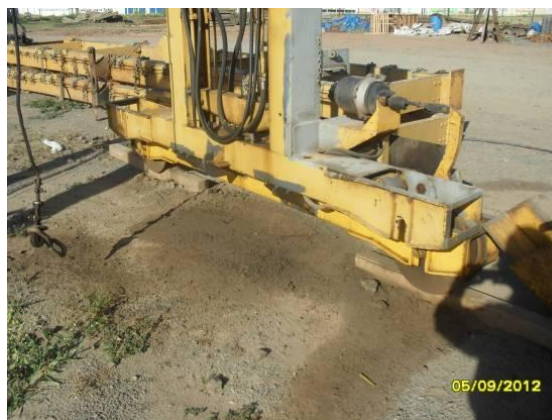
Foto 4-45 Máquina em manutenção sem bandeja de contenção contaminando o solo próximo a oficina da TIISA/CMC.
