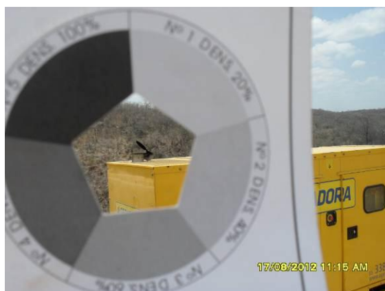
Foto 4-93 Teste da emissão de fumaça negra em grupo gerador na estaca 14395.
