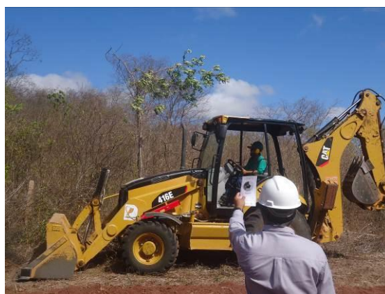
Foto 4-94 Monitoramento da emissão de fumaça negra em retro escavadeira na estaca 16576.
