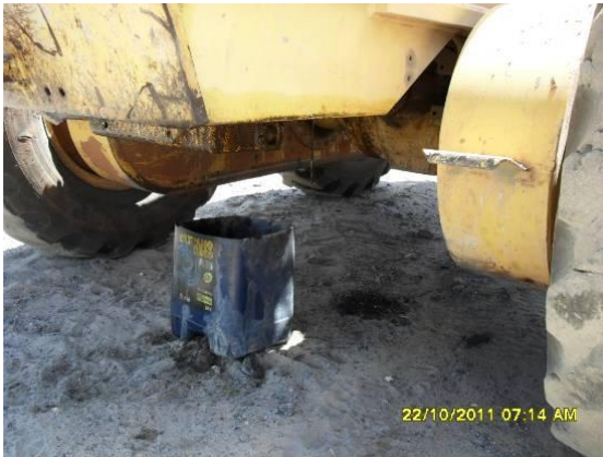
Foto 4.1.171 Máquina com vazamento de óleo sem bandeja de contenção, contaminando o solo no pátio do britador, Sitio Olho d'Água Cercado, Milagres/CE.
