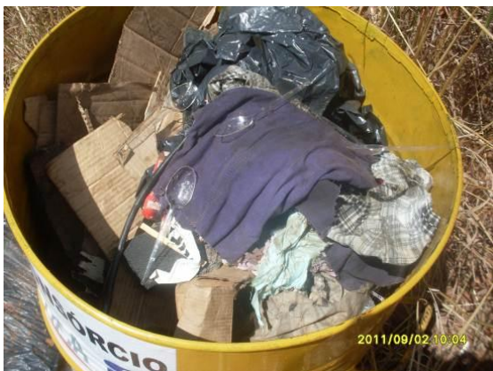
Foto 4.1.137 Resíduos contaminados por óleo e graxas juntos com outros materiais, estaca 16927.
