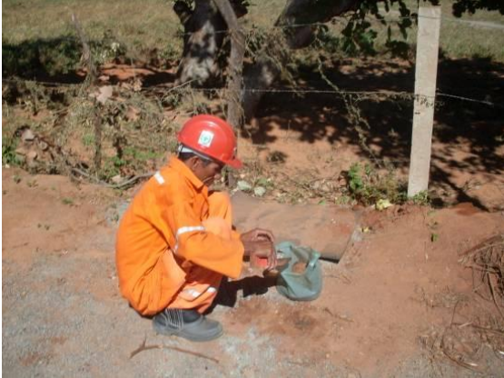
Foto 4.1.115 Colaborador do consorcio TIISA/CMC colhendo solo contaminado por óleo, estaca 16182.
