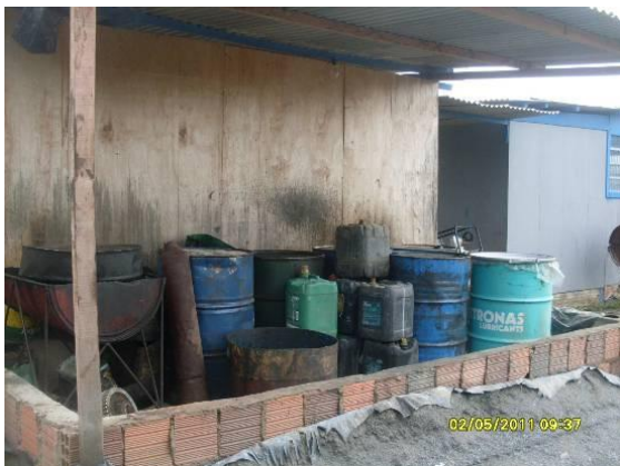
Foto 4.1.84 Baias para o armazenamento dos resíduos oleosos.
