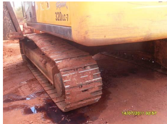
Foto 4.1.108 Máquina da POLLIAN com problema mecânico derramando óleo no solo, estaca 16157.
