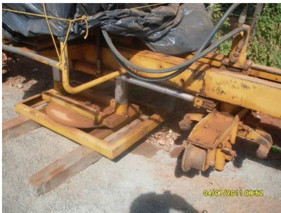
Foto 4.1.103 Máquina para manutenção sem bandeja de contenção, estaca 16182.
