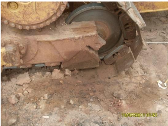
Foto 4.1.107 Máquina da TIISA com problema mecânico contaminando o solo, estaca 15784.
