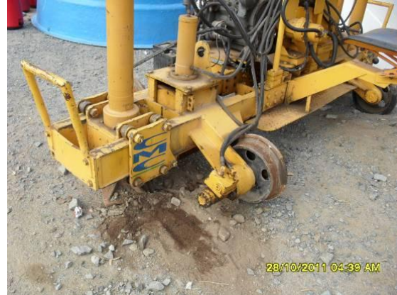
Foto 4.1.162 Máquina com vazamento sem bandeja de contenção, ponto de apoio do Consórcio TIISA/CMC, em Brejo Santo/CE.
