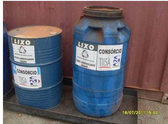
Foto 4.1.106 Tambores com óleo usado, dentro de bandeja de contenção, estaca 16182.
