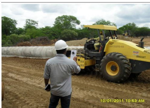
Foto 3-3 Técnico Ambiental realizando medição do nível de fumaça preta do Programa de Qualidade do Ar
