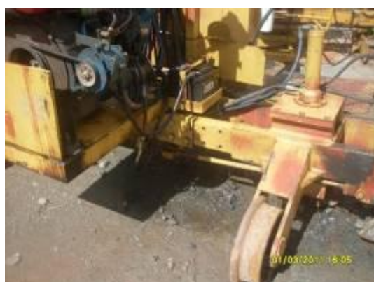
Foto 4-59 Solo contaminado por falta de bandejas de contenção.
