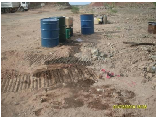
Foto 4-63 Solo “contaminado” com óleo lubrificante.
