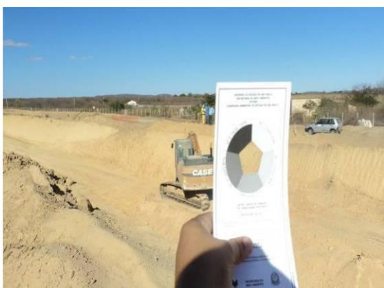
Foto 3-71 Medição de fumaça negra com auxílio da tabela Ringelmann, próximo a estaca 73100.
