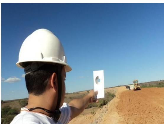
Foto 3-72 Medição de fumaça negra com auxílio da tabela Ringelmann, próximo a estaca 72988.
