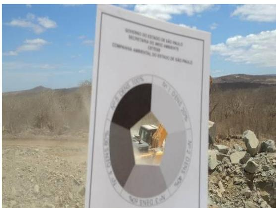
Foto 3-73 Medição de fumaça negra com auxílio da tabela Ringelmann, próximo à estaca 71042.
