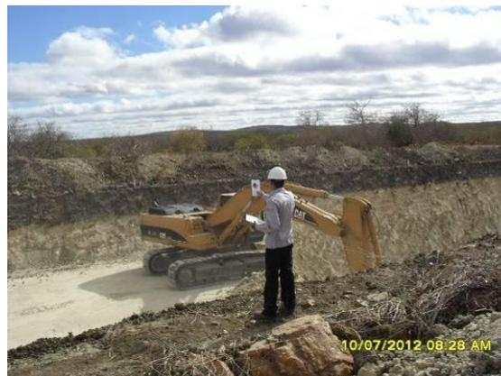
Foto 3-68 Medição de fumaça negra com auxílio da tabela Ringelmann, próximo a estaca 61679.
