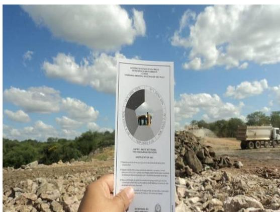
Foto 3-73 Aferição de fumaça negra em trator de esteira D-8, estaca 71454.
