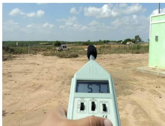
Foto 3-70 Aferição do nível de ruídos, próximo a estaca 73100.
