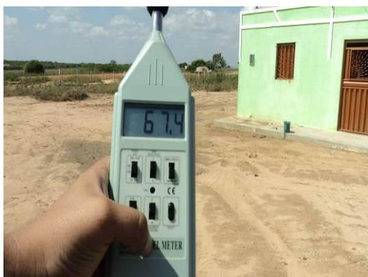
Foto 3-69 Aferição do nível de ruídos, próximo a estaca 73100.
