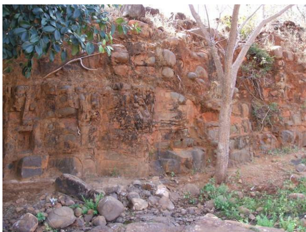
Foto 4.1-3 – AID - Vista de pedreira escavada em diabásio, rocha utilizada como agregado de concreto e enrocamento na barragem do Vale do Itauera. Observar esfoliação esferoidal característica. Município de Itauera (Ponto 101).
