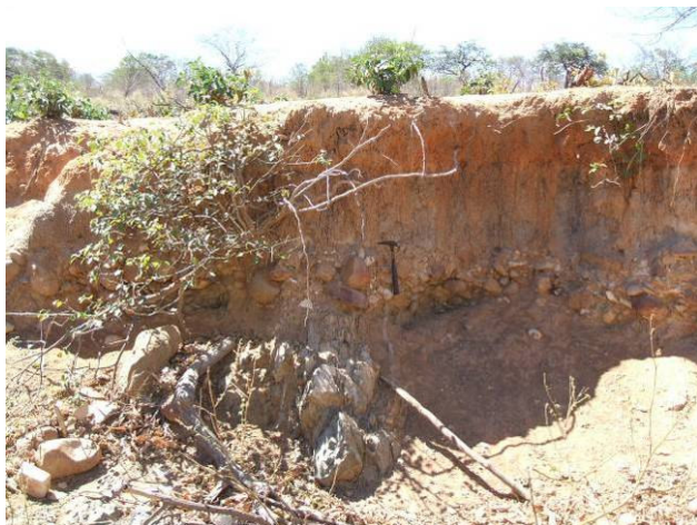
Foto 4.1-67 – AID/ADA – Perfil de solos exposto na margem do riacho Olho D'Água: 0,70m de solo coluvionar areno-argiloso sobreposto a horizonte de cascalhos grosseiros de 0,15m de espessura, assentado sobre rocha gnáissica com foliação subvertical.
