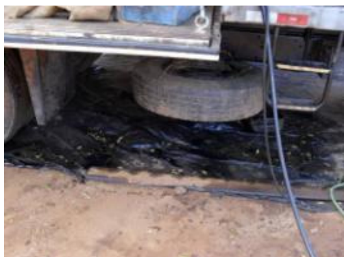
Foto 4-33 Equipamento com vazamento grande de óleo
