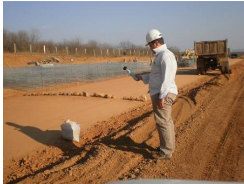
Foto 4-58 – Medição de emissão de ruído sonoro.
