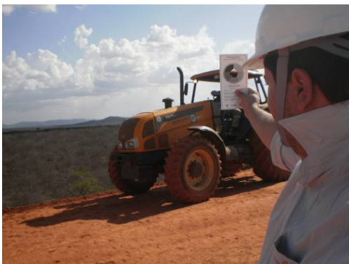
Foto 4-56 – Medição de emissão de fumaça negra (estaca 935 Lote 2).
