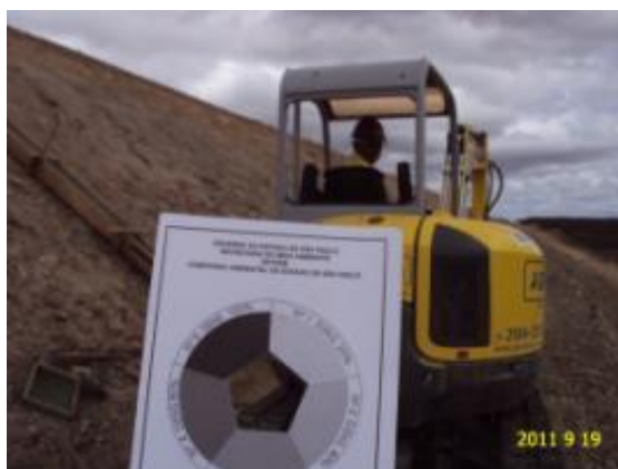
Foto 3-65 Monitoramento da fumaça negra pela Escala Ringelmann.
