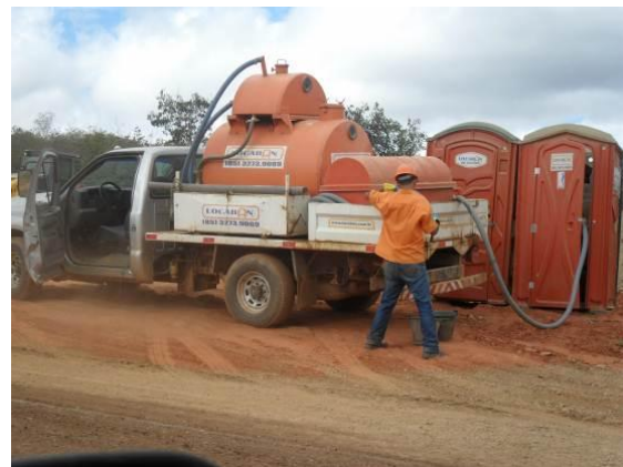
Foto 3-42 A captação dos efluentes líquidos e a higienização dos banheiros são realizadas por uma empresa especializada.
