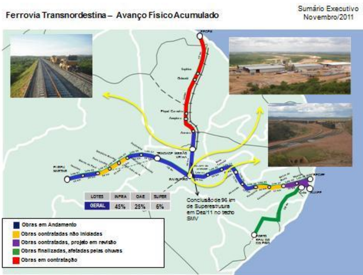
Figura 2-1 Visão geral do andamento das obras em todos os Trechos da Ferrovia Transnordestina.
