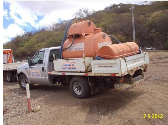
Foto 3-72 Caminhão de coleta dos efluentes sanitários.
