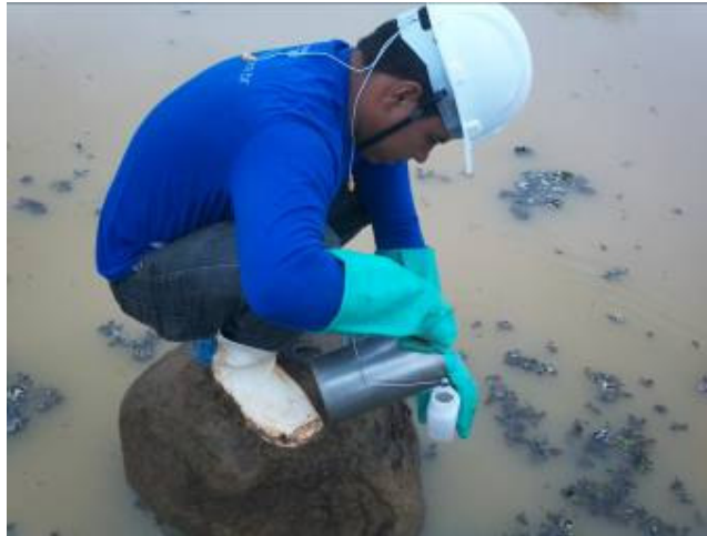
Foto 5.1.2-3 – Açude Cachoeirinha (PE 05): coleta de amostras para análises físico-químicas e bacteriológicas em techo com macrofitas aquáticas.
