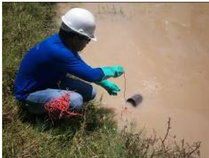
Foto 5.1.3-2 – Riacho do Mel/Pereiras (PE 23J): coleta de amostras para análises físico-químicas e bacteriológicas.
