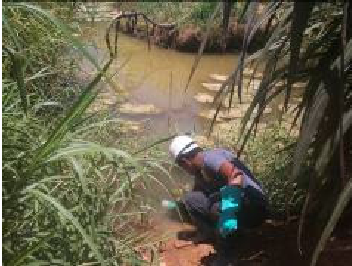
Foto 5.1.1-6 – Riacho Formiga (PE 01AJ): coleta de amostras para análises físico-químicas e bacteriológicas.
