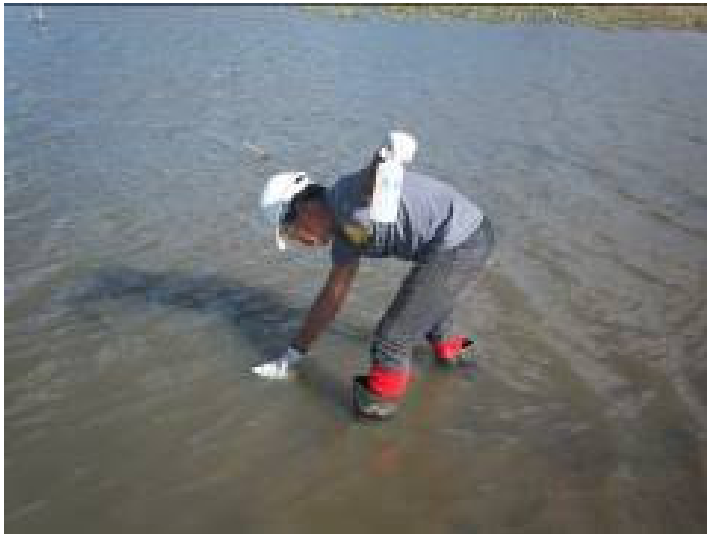
Foto 5.1.2-8 – Açude Varzinha (PE 09J): coleta de amostras para análises físico-químicas e bacteriológicas.
