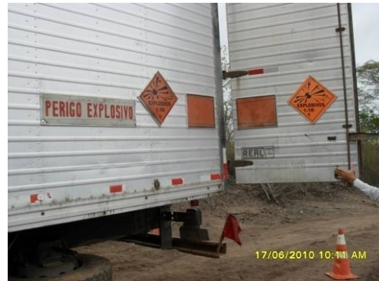
Foto 4-68 Veículo de explosivo, devidamente sinalizado e dentro dos padrões exigentes.
