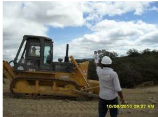
Foto 4-72 Inspeções utilizando a Escala Ringelmann.
