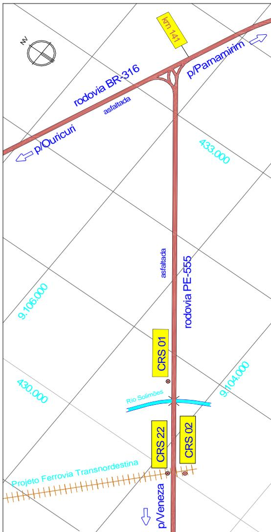
Partindo do trevo de interseção das rodovias BR-316 e da PE-555, segue-se pela rodovia PE-555, numa distância de 3400m em direção a cidade de Petrolina, encontra-se a ponte sobre o Rio Solimões. Da ponte segue-se por mais 740m, encontra-se a picada do eixo do Projeto da Ferrovia Transnordestina. O marco de concreto CRS 02 esta implantado a esquerda da rodovia a 105m do eixo da mesma.
