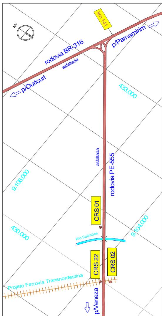
Partindo do trevo de interseção das rodovias BR-316 e da PE-555, segue-se pela rodovia PE-555, numa distância de 3250m em direção a cidade de Petrolina. O marco de concreto CRS 01 esta implantado a direita da rodovia na parte superior do talude de corte a 3m da crista do corte.
