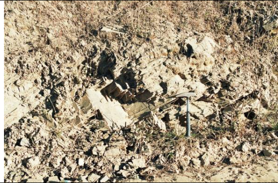
Foto 15_0270 (pto. 61): xistos da formação Santana dos Garrotes, alterado e com padrão de diaclasamento bem desenvolvido, aflorando a 600 m do local do traçado.
