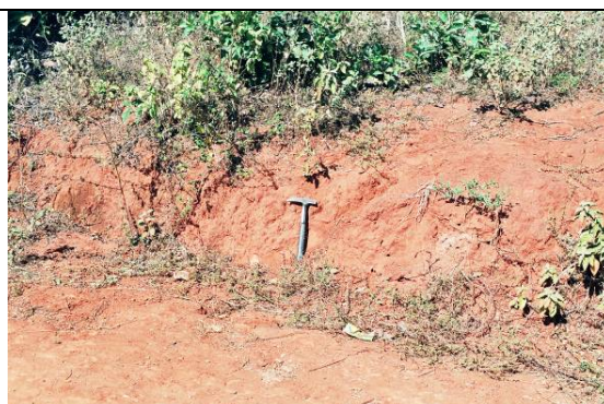
Foto 26A_0210 (pto. 55): cobertura coluvial arenosa junto ao traçado da ferrovia.
