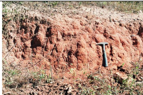
Foto 19_0168 (pto. 42): solo areno-silto argiloso com 1 m de espessura, recobrendo rocha que aflora no leito da estrada (v. foto seguinte).
