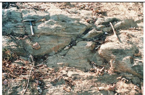
Foto 6A_0191 (pto. 49): gnaisse quartzo-feldspático micáceo alterado em área de domínio da Unidade Acopiara, onde passa o traçado da ferrovia, próximo à localidade de Volta.
