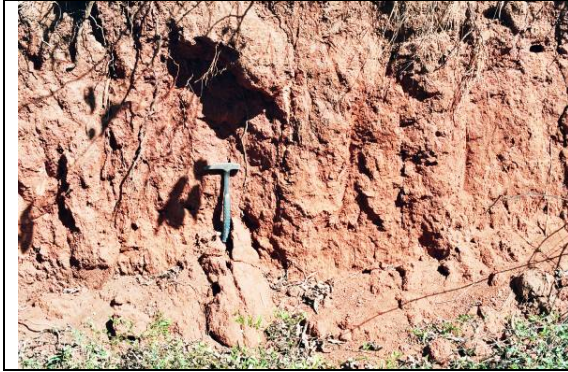
Foto 29A_0213 (pto. 54): cobertura coluvial arenosa com pouca argila, sobre saprolito de gnaisses do Complexo Jguaretama, no local com erosões no leito de estrada próximo ao traçado da ferrovia da CFN (v. fotos anteriores).
