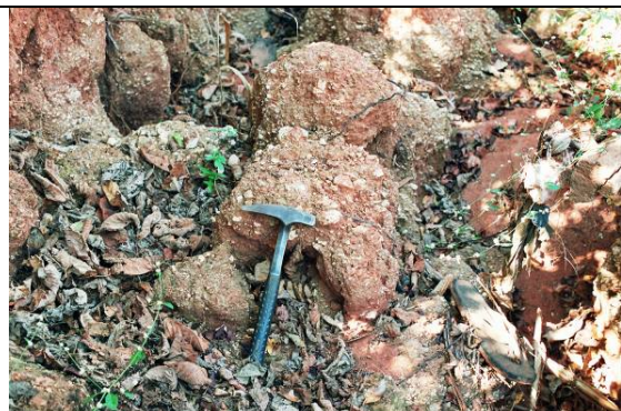
Foto 28A_0212 (pto. 54): torrões de solo com fragmentos placóides de material silicoso, no início de ravina de erosão, possivelmente pertencentes a unidade sedimentar, no contato com o embasamento.
