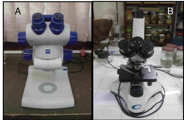
Foto 10 – Aparelhos empregados na biometria dos peixes coletados e análises biológicas: estereomicroscópio (A) e microscópio ótico (B).
