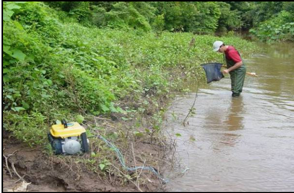
Foto 7 - Uso de aparelho de pesca elétrica para a complementação da coleta de peixes.
