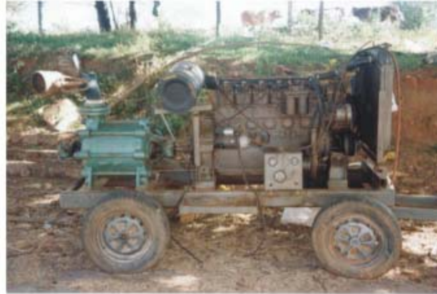
Conjunto moto-bomba (conjunto de irrigação).
