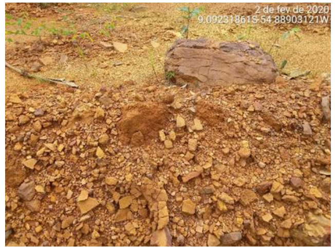
Rocha e fragmentos de rocha laterizados utilizados como empréstimo.
