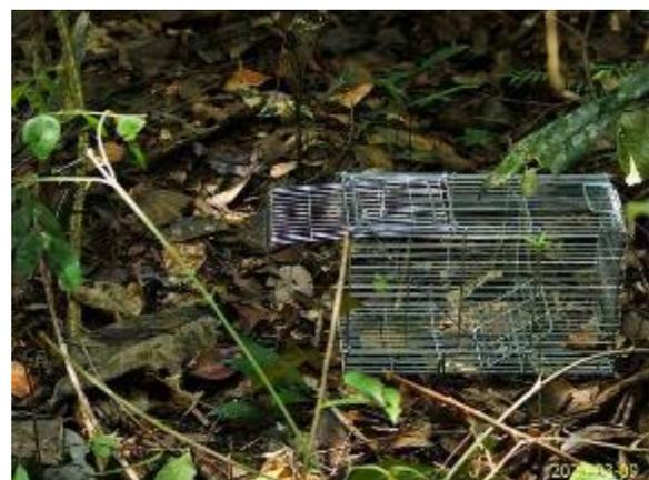
**Foto 342 – Armadilha Live Trap do Tipo *Tomahawk* Alocada ao Nível do Solo no Módulo VI Durante o Diagnóstico de Fauna da EF-170 (21 M 614580/9493826).**
