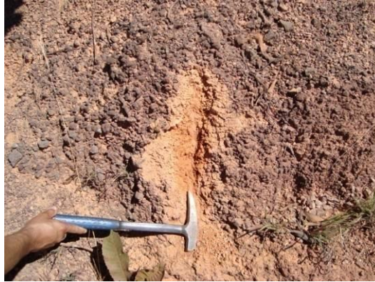
Figura 5.1-150 - Ponto amostral 13, com destaque para o Plintossolo Concrecionário. Coord. UTM: N8393530/ E601031.
