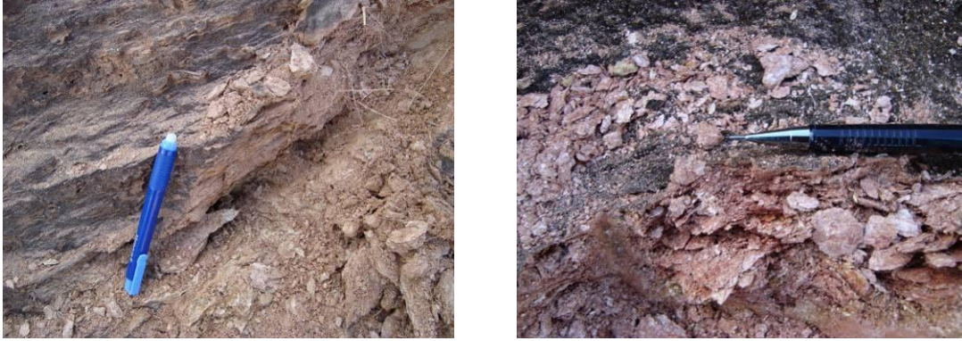
Figura 5.1-29 - As duas fotos expressam o detalhe do xisto de coloração avermelhada que por vezes se apresenta mais resistente em camadas de textura arenosa (esquerda). À direita pode-se observar as placas de argilominerais que desenvolve a xistosidade do pacote. Coord.: 22L 681.218/8.419.970.
