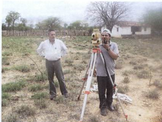
Figura 7 – Levantamento topográfico no lote 3 da FIOL, em área de vegetação rasteira.
