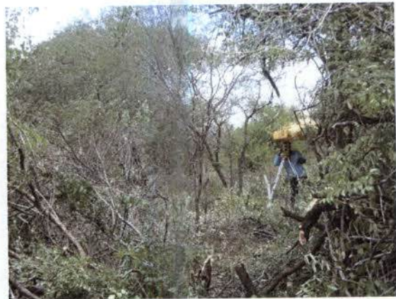
Figura 10 – Levantamento topográfico no lote 4 da FIOLE, com destaque para galhos cortados sem a necessidade de supressão das árvores.
