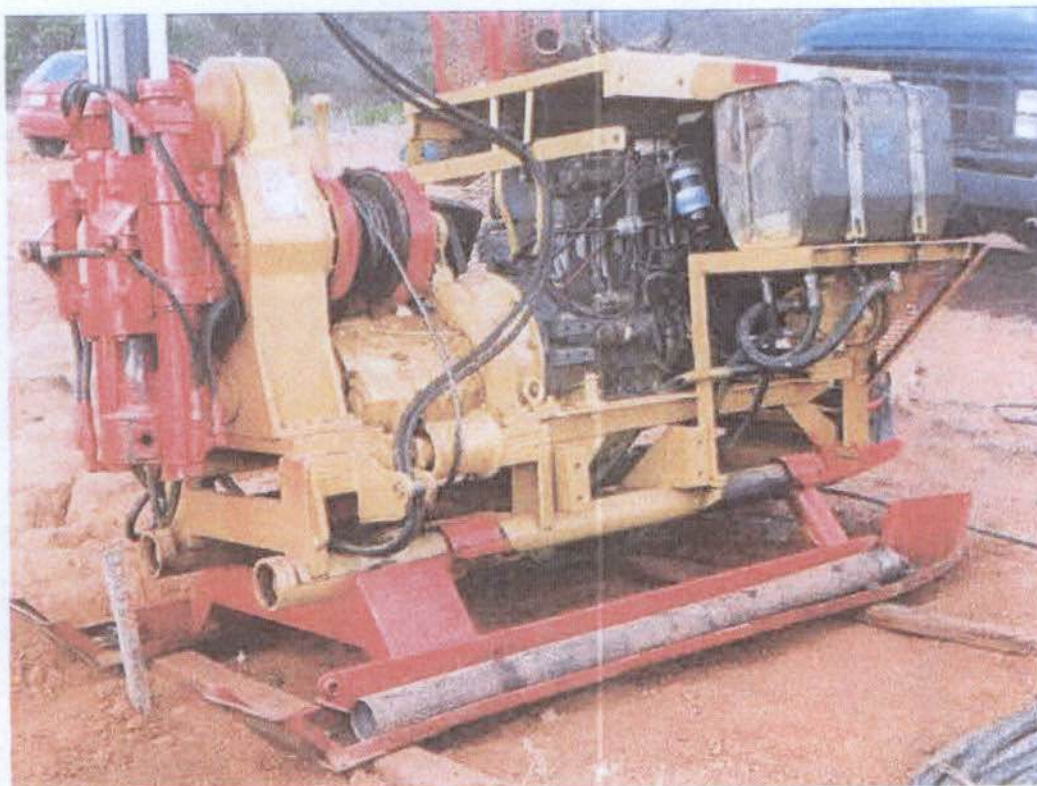
Foto 13. Equipamento de execução de sondagem mista utilizado
