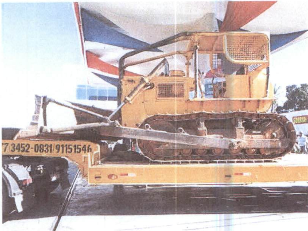
Foto 20. Equipamento que deverá ser utilizado na abertura dos acessos – Trator Esteira
