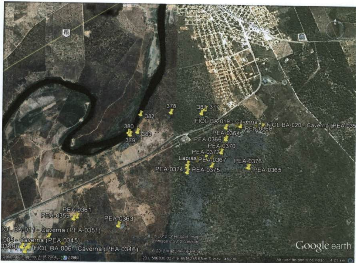
Figura 3. Localização das cavidades cadastradas no banco de dados do CECAV, na região da variante de São Félix do Coribe. Na área destacada localiza-se a cavidade vistoriada PEA 354 (e mais 18 cavidades) e seria afetada pelo traçado original, justificando a necessidade de uma variante neste trecho (imagem do Google Earth™ serviço de mapa).
