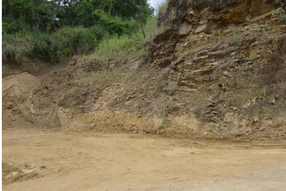
Foto 02 – KM 1425 – Rocha alcalina alterada bastante fraturada.
