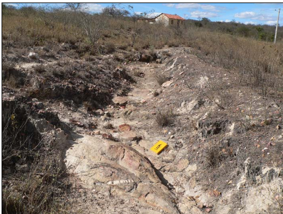
Figura 22: material de 2ªCat. e a RAD praticamente aflorando
