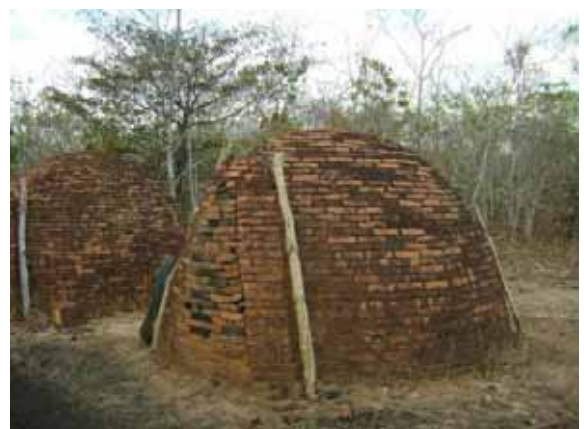
Fornos de carvoaria (2 unidades de forno rabo-quente) com biomassa (lenha) em seu interior.
