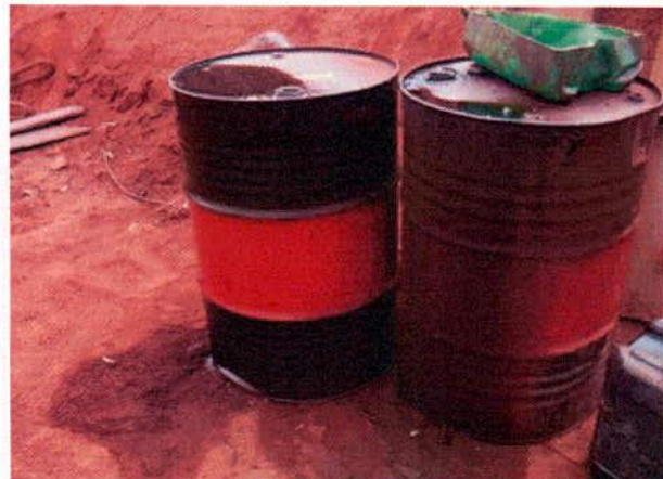
FIGURA 182 – Tambores com óleo usado (graxa) diretamente sobre o solo, com vazamento.
