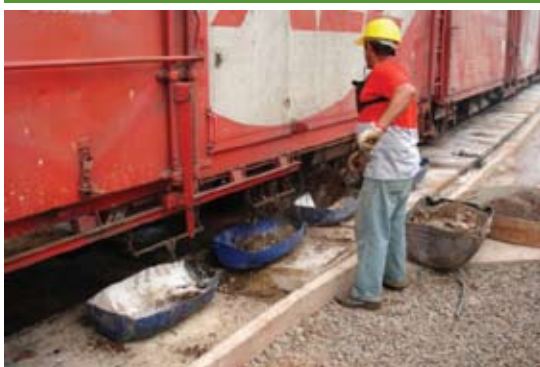
Lavagem interna do piso.
