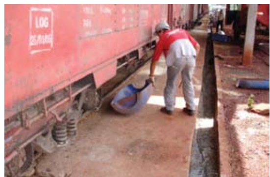
Abertura das bicas e colocação das bandejas.
