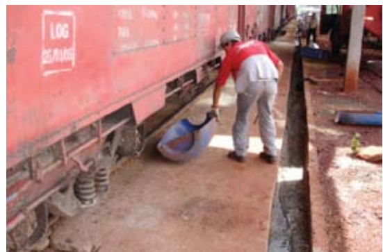
Varrição das bicas de descarga.
