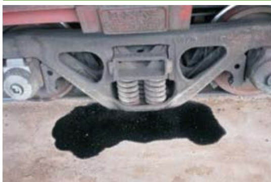
Óleo lubrificante da pista que deve ser limpo com material absorvente.
