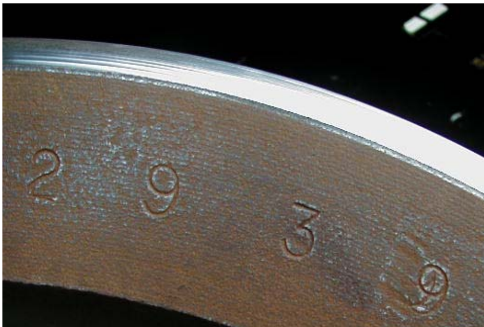
Fig. 3 – Roda de vagão com marcação a frio no aro
