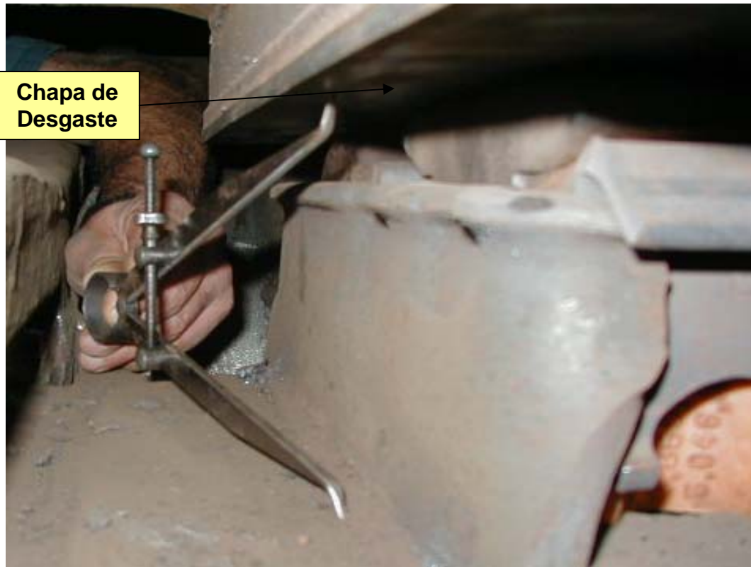
Figura 11 – Maneira correta de proceder a medição
