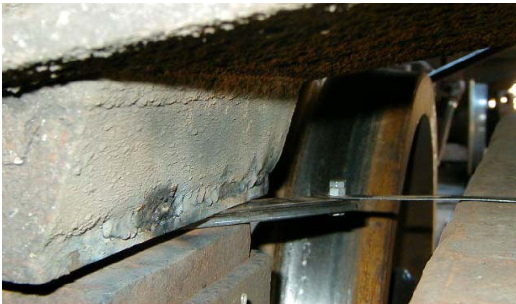
Figura 8 – Forma correta de utilizar o calibre de folgas (neste caso a folga é de 9 mm).
