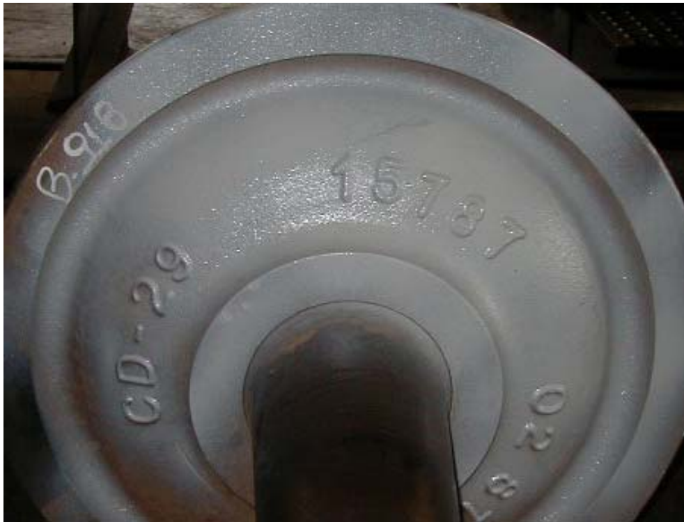
Fig. 2 – Roda de vagão com marcação alto relevo no disco da roda
