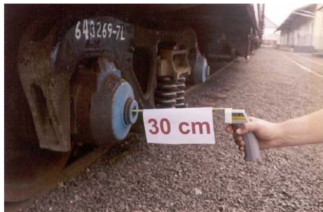
Figura 1 – distância correta para efetuar a medição de temperatura
