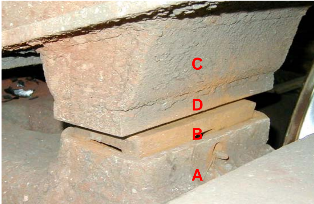
Figura 1 –Ampara - balanço com folga.Coxim(a), castanha(b), calço superior(c), chapa de desgaste(d)
