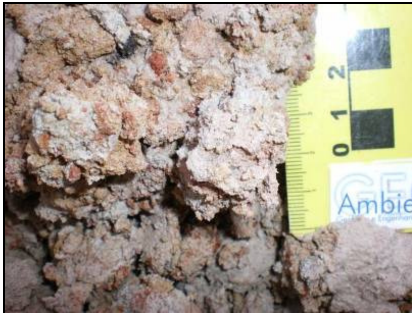
Figura 48 – Solo areno-siltoso da sondagem ST-03.
