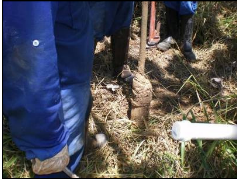
Figura 57- Detalhe do trado na execução da sondagem ST-07.
