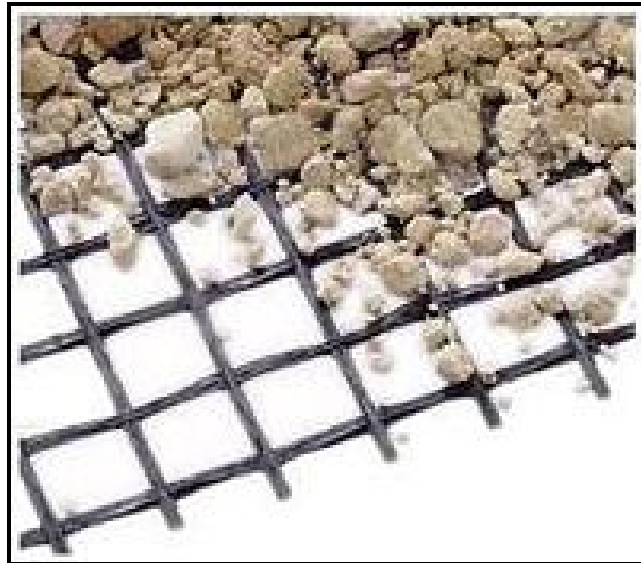
Figura 52 – Modelo de interação geogrelha e solo.
