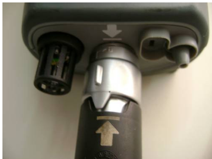
(Fig.6 Cabo Destravado)
