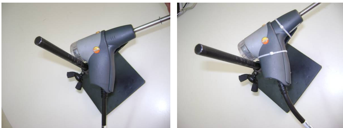
(Fig.4 Montagem base magnética com haste coletora)
