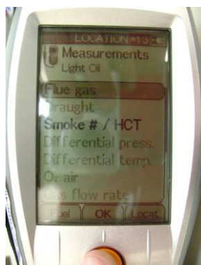
(Fig.9 FLUE GAS)
