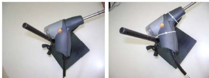
(Fig.4 Montagem base magnética com haste coletora)
