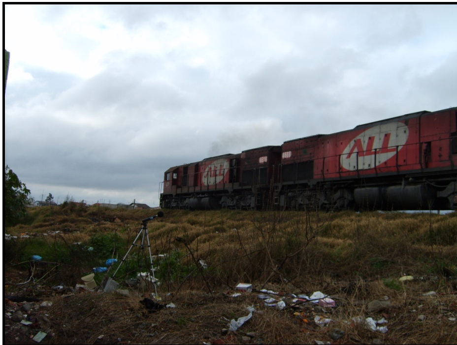
Figura 12.7-1 – Medição de Ruído Próximo à Via Permanente
