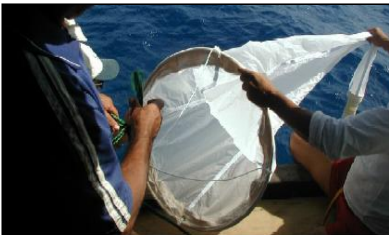
Foto 10 - Redes de plâncton com malha de 65 \mu\text{m} .
