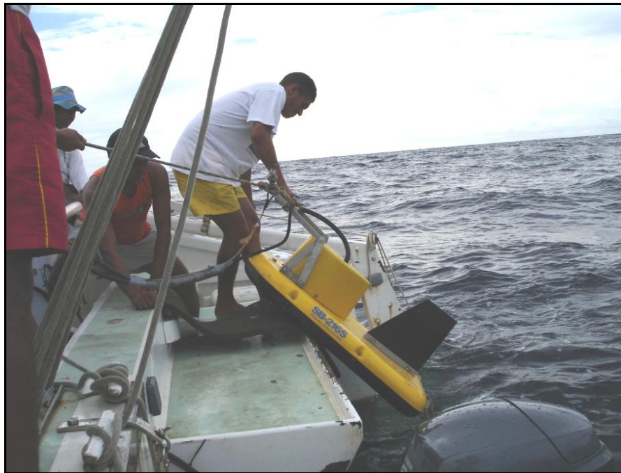
Foto 6 - Sensor da sísmica de alta resolução (Tow-Fish SB216S) sendo lançado para reboque sobre o fundo.
