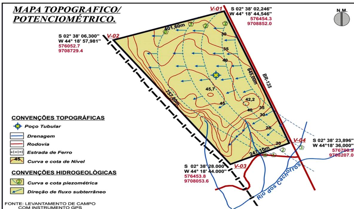
Figura 9 - Mapa topográfico/potenciométrico. Ver sentido do fluxo.
