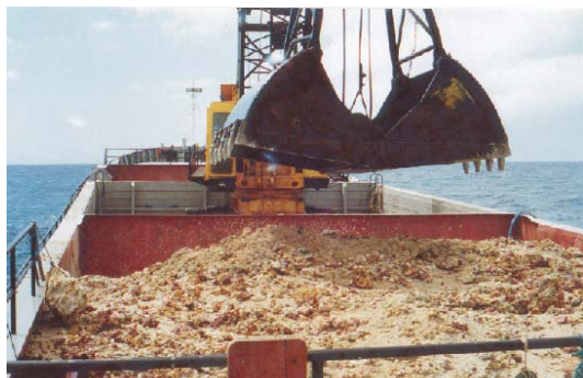
Figura 3.1-2: Operação da draga Clam-Shell armazenando o material no compartimento de carga.
