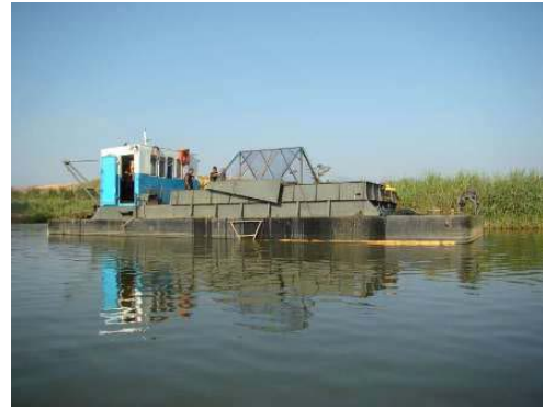
Figura 3.1-12: Draga Siluma durante atividade de dragagem de areia em rio (carregada).
