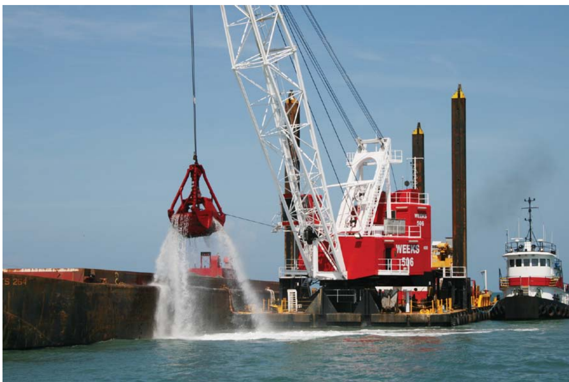
Figura 3.1-1: Draga estacionária com caçamba em forma de concha ou draga Clam-Shell .
