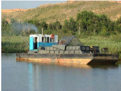
Figura 3.1-11: Draga Siluma durante atividade de dragagem de areia em rio.
